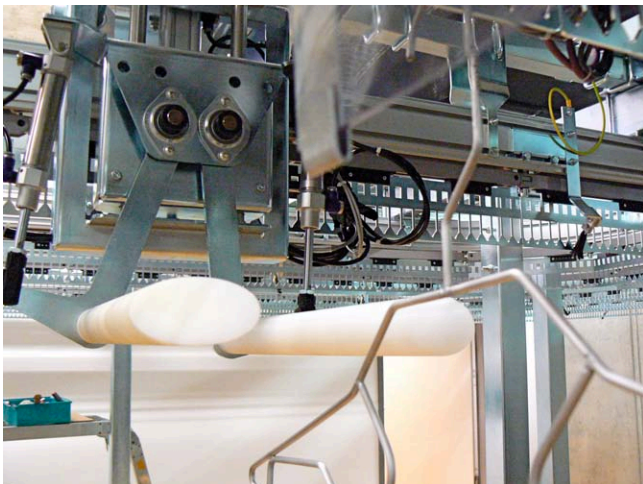
Leerbügel werden automatisch aussortiert und neue Bekleidung an einer freien Stelle einsortiert.
