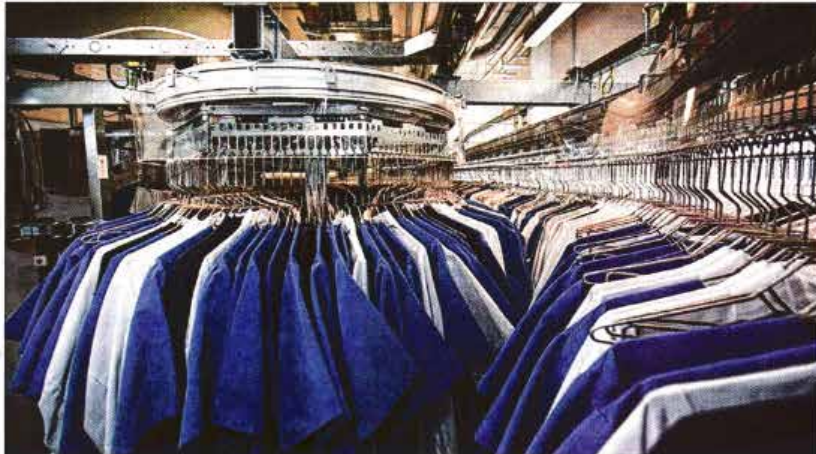
Sauber und glattgebügelt kommt der Kittel von Barbara Vetter aus dem Wäscheautomaten in der Neuen Chirurgie. Dahinter steckt ein ausgeklügeltes System: Etwa 2800 Kleidungsstücke kreiseln auf einer 140 Meter langen Förderanlage. Benutzte Wäsche kommt ins Rückgabefach. Fotos: Volkmar Kanneke
